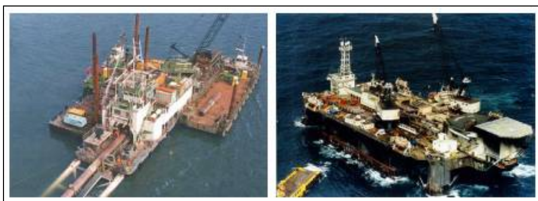
Ilustracja 3.7 Przykłady barek układających do płytkich wód i pełnego morza przedstawione z barkami do dostawy rur obok burty
