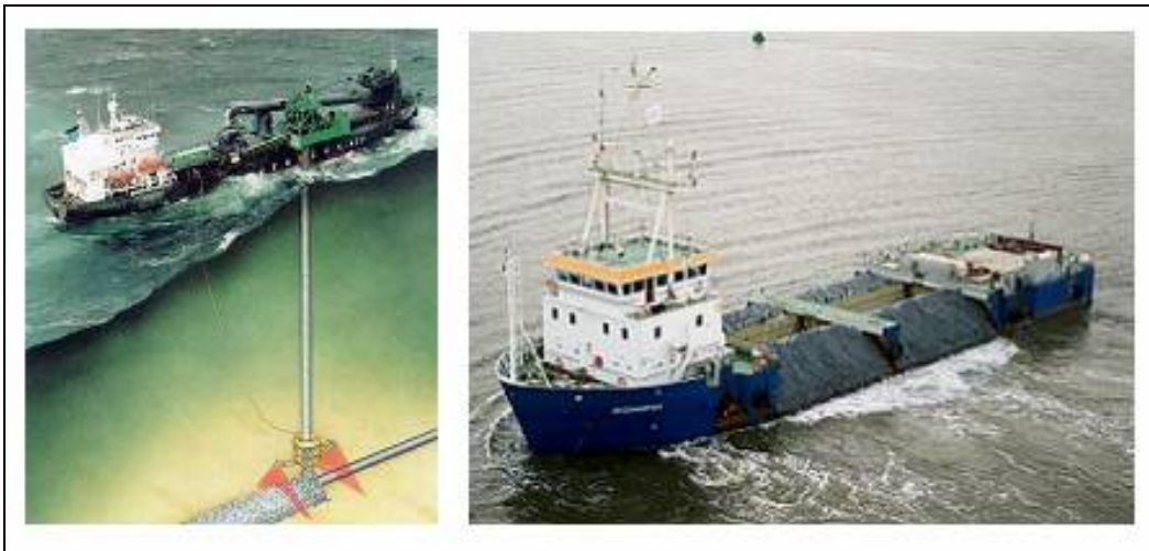
Ilustracja 3.9 Przykład statku do zasypywania skalnego. Statek z pionową rurą po lewej oraz statek do bocznego zasypywania po prawej
